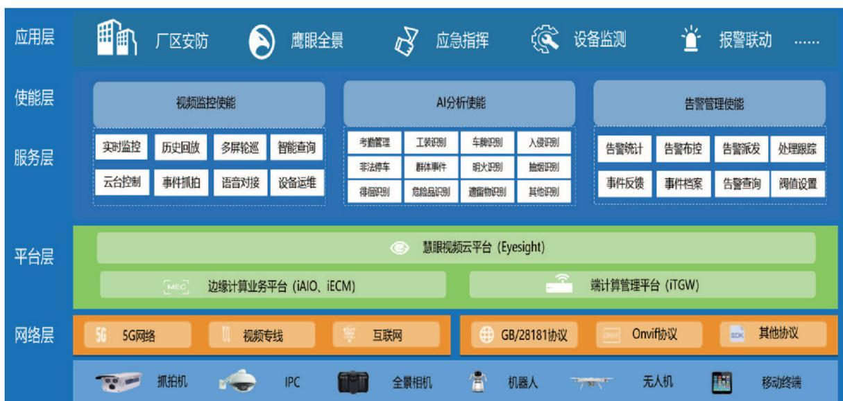
制造资源数据的采集与传输，包括加工设备、测试设备、工装工具、人员、环境、用能、仓储等方面，为透明车间的实现提供了基础。同时通过打造5G专网部署的UPF或边缘计算平台MEC，实现采集数据不出客户厂区，保障生产数据安全。
